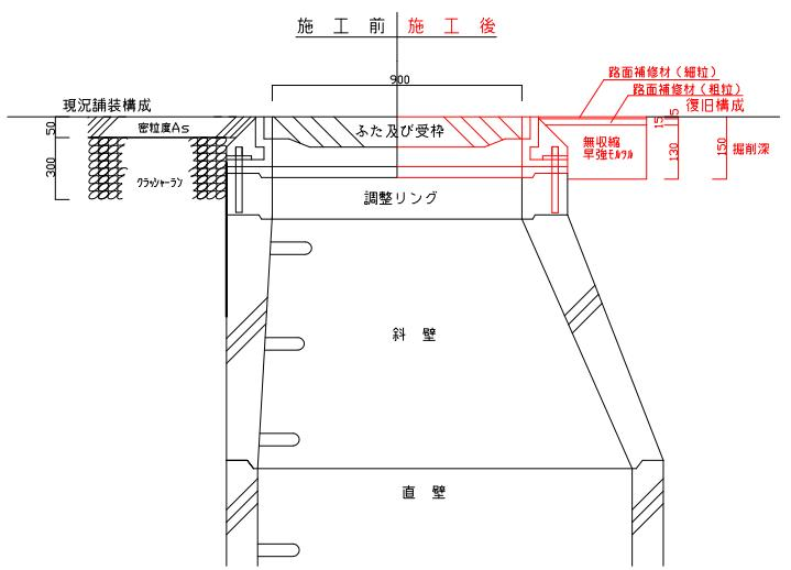
鉄蓋(受枠共)交換平面図
