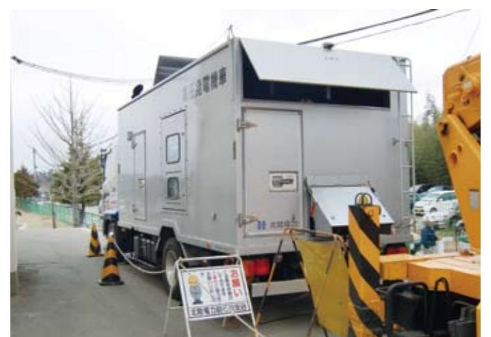
電力を供給する北陸電力の高圧発電機車
