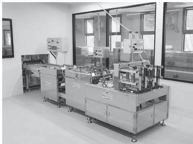
1時間に10万枚の焼き海苔を作ることができる設備を設置しています
