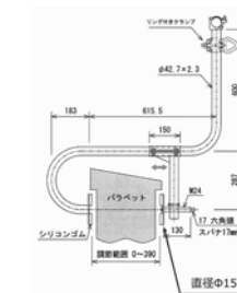
仮設用ハシゲ安全手摺詳細参考図 S=1:20
