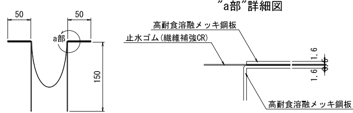
クローザー詳細図 (クローザーS)
